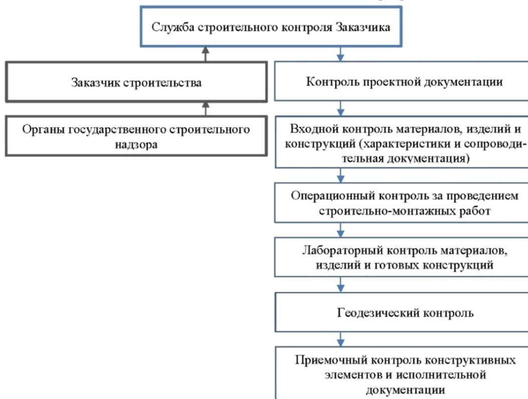
Рис. 1. Структурная схема контроля заказчика строительства
