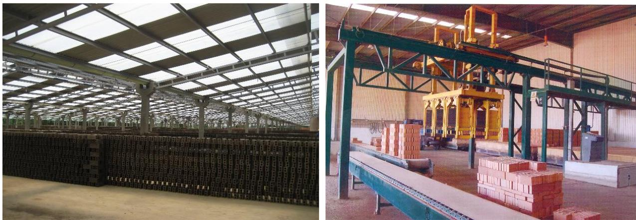
Рис. 5. Процесс производства стенового керамического кирпича из отходов углеобогащения на заводе Хью Хунг
