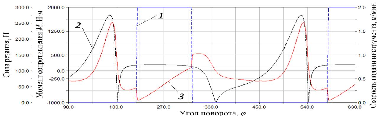
Рис. 7. Результаты моделирования механизма в среде MSC Adams: 1 – сила резания; 2 – скорость подачи инструмента; 3 – момент сопротивления
